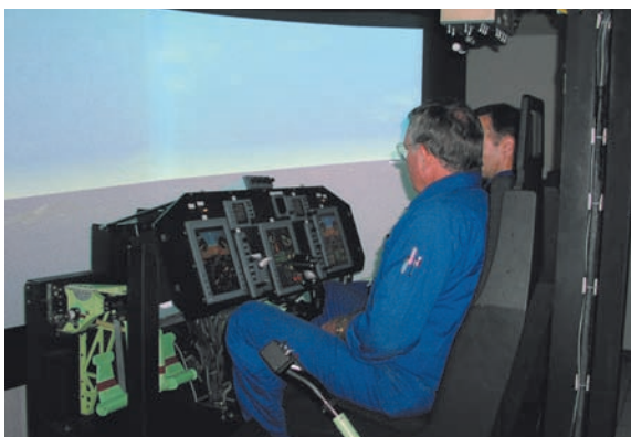
Bells HIL-Prüfstand mit seinen drei Flight Control Computern, elektrohydraulischen Aktuatoren sowie Geräten zur Ausübung simulierter Belastungen auf die Aktuatoren
