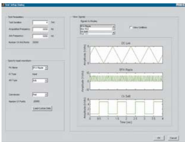
Abb. 4: Die VDT-Anwendung stellt Ein- und Ausgabesignale nebeneinander auf einer Zeitachse dar.
