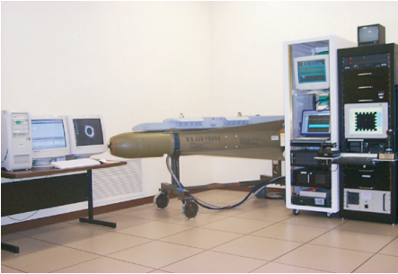
OGT(Operational Ground Test)를 위한 실시간 테스트 시스템
