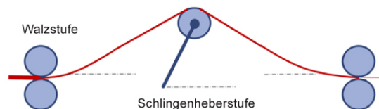
Abb. 1: Schema des Walzverfahrens.
